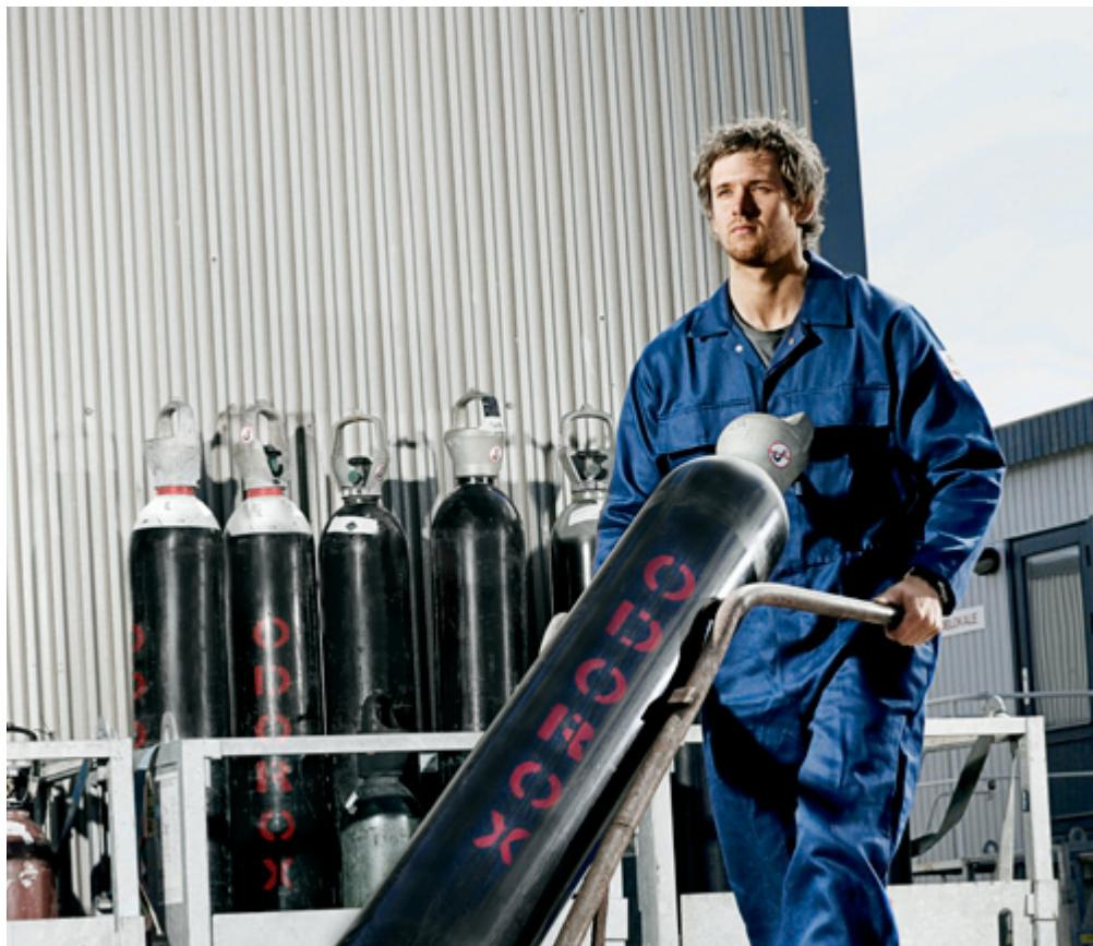
ODOROX® kan leveres i flasker og batterier. Den omgivende luft har en oxygen-koncentration på 21%. En forøgelse af oxygen-koncentrationen betyder en hurtigere forbrænding. Stiger oxygenkoncentrationen med 3% (til 24%), vil forbrændingshastigheden blive fordoblet. Indeholder luften 40% oxygen, er forbrændingshastigheden 10 gange det normale. ODOROX® forøger sikkerheden på arbejdspladsen, men må ikke betragtes som en erstatning for de øvrige normale sikkerhedsforanstaltninger.
